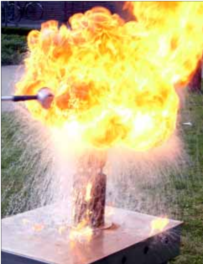
150 ml Pflanzenöl „gelöscht“ mit 250 ml Wasser ergibt eine Feuerwalze mit bis zu 4m Höhe - das soll nicht passieren!
